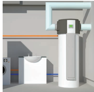
Anschluss mit Kanal an Außenluft: kein Einfluss auf die Raumtemperatur am Installationsort
